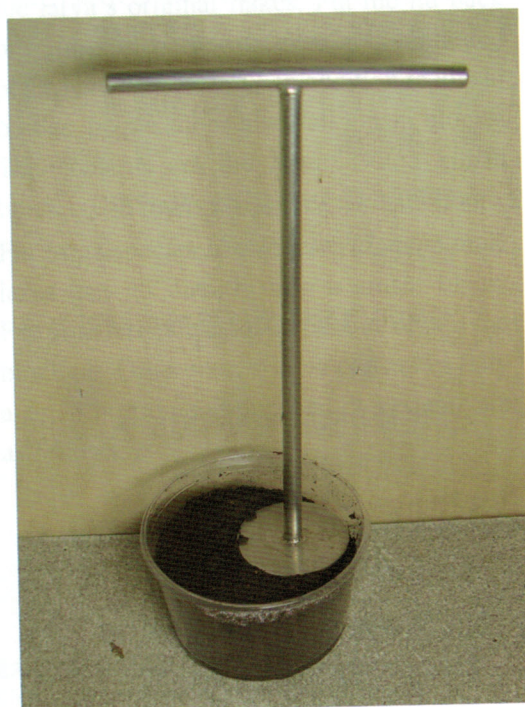
↗擠壓棒使用情形。 Substrate compressor in action.
